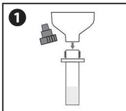
① 抽出チューブのキャップを外し、検体採取カップを取り付ける。
