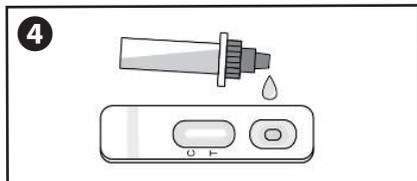
④ で混ぜた液をテストカード下段の穴に4滴入れます。
